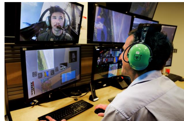
L'un des instructeurs de CAE surveille un élève pilote de la RAAF sur un simulateur Hawk Mk127 à la RAAF Pearce lors d'un essai de la technologie de suivi oculaire.
