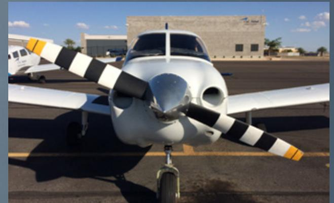
En ajoutant des lignes noires sur les hélices, des cercles concentriques sont visibles lorsque les hélices sont en mouvement.
