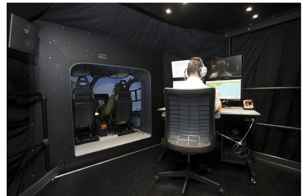
**Le nouveau dispositif d'entraînement au vol CAE 700MR est doté d'un poste de pilotage spacieux pour les instructeurs et les membres d'équipage arrière, comme le montre le dispositif d'entraînement au vol H135 pour le programme MFTS du Royaume-Uni.**
