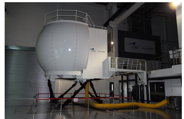
Le simulateur de vol S-92 de Série CAE 3000 au centre MPTC de CAE Brunei
