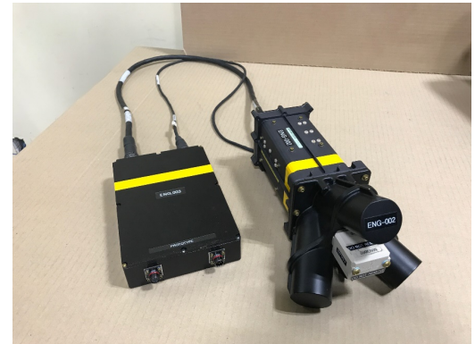
Le système CAE MAD-XR est beaucoup plus compact que le système MAD précédent ce qui lui permet d'être utilisé sur un plus grand nombre de plateformes comme les hélicoptères, les UAV et les aéronefs à voilure fixe de plus petite taille.
