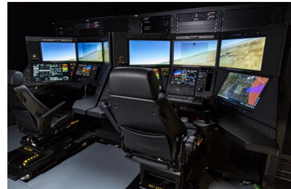
Les dispositifs d'entraînement aux missions haute fidélité Protector développés par CAE seront basés sur la station de contrôle certifiable au sol de General Atomics. Images fournies par GA-ASI.
