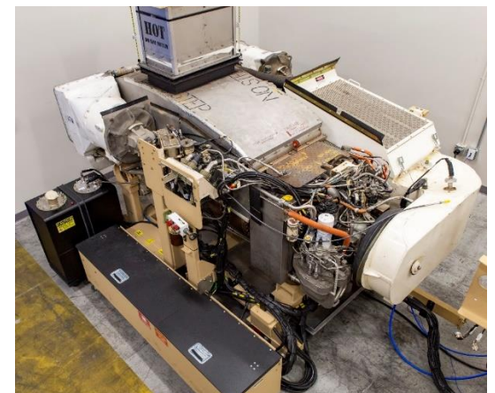
Le dispositif d'entraînement Abrams soutiendra les tâches de formation relatives au diagnostic et à la résolution de problèmes de maintenance.
